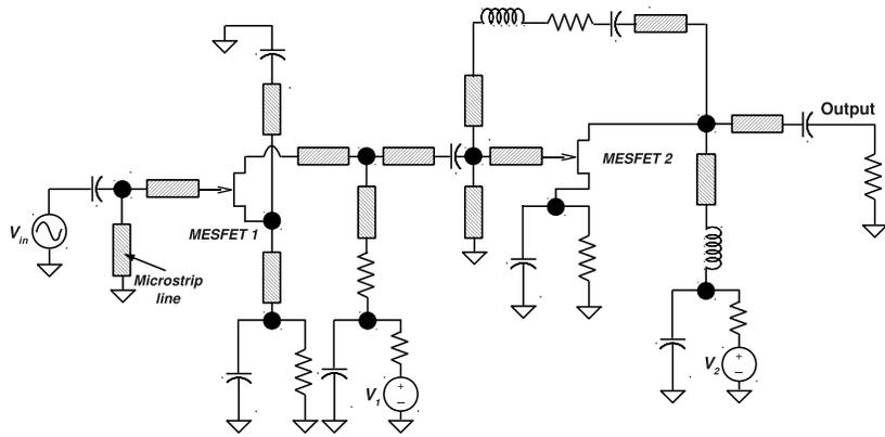
Figure 3: X-band MMIC LNA (LMA 411)
